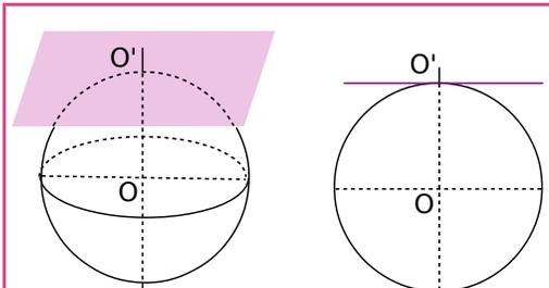
Quand la distance  $OO'$  correspond au rayon de la sphère, la section est alors réduite au point  $O'$ . On dit que le plan est **tangent à la sphère en  $O'$** .
