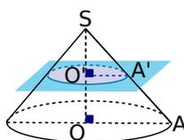
La section d'une pyramide ou d'un cône de révolution par un **plan parallèle à la base** est une réduction de la base.
