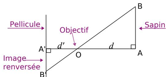
Voici un schéma du fonctionnement d'un appareil photographique argentique : un objet [AB] situé à une distance  $d$  de l'objectif O a une image [A'B'] située à une distance  $d'$  de O.
