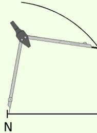
On construit un segment [NU] de 14 cm. On trace un arc de cercle de centre N et de 11,6 cm de rayon.
